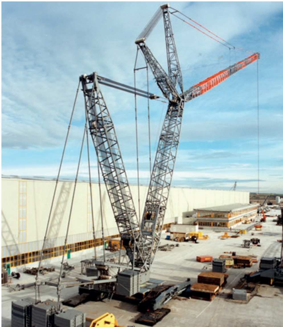
EEN NIEUWE RUPSKRAAN UITGERUST MET STEMPELPOTEN OP HET TESTTERREIN VAN LIEBHERR
