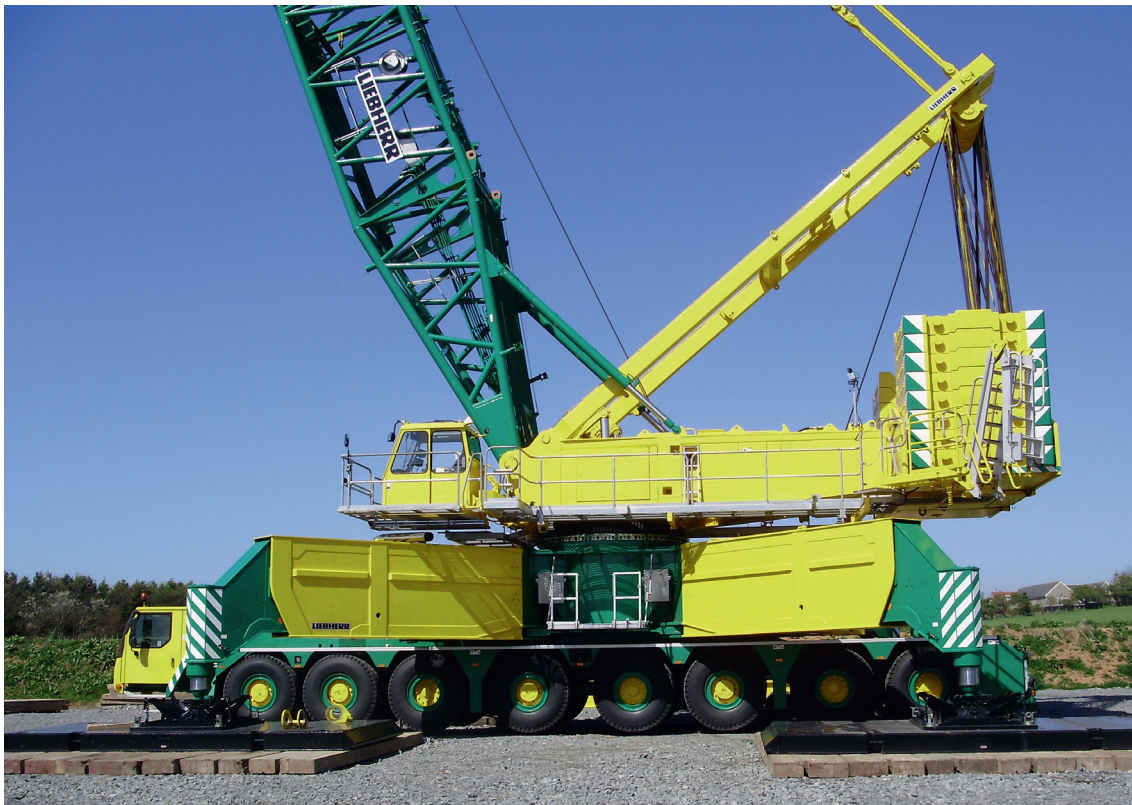
FOTO 3.3 DE LIEBHERR LG1750, EEN OPBOUWKRAAN MET EEN ONDERWAGEN OP BANDEN
